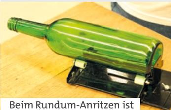
Beim Rundum-Anritzen ist entscheidend, dass man das Werkstück gerade führt.
